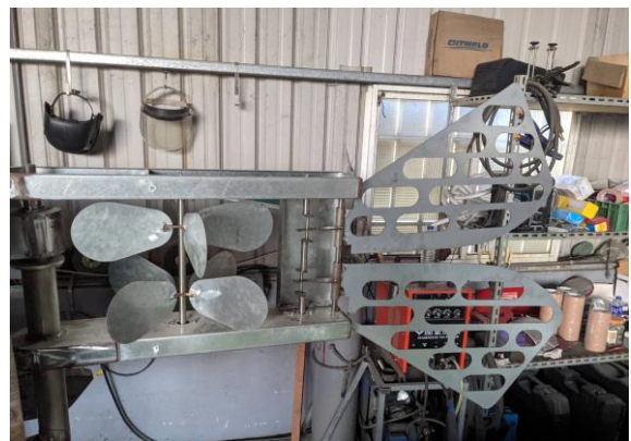
尾鰭風動機構組立焊接
